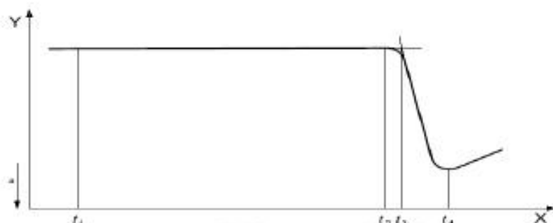
Рисунок 4 – Типичная кривая ДСК при определении термостабильности
